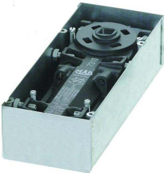
Force réglable de 5-21Nm. 2 vitesses de fermeture (initiale et à-coup final) réglables indépendamment par 2 valves thermostatiques. Pour portes double action jusqu'à 120Kg.
