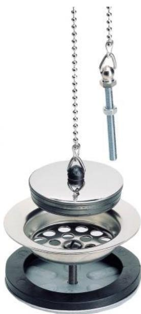
Plateau de bonde en inox avec bouchon chaînette pour évier grès de perçage Ø60mm avec trop plein incorporé. Epaisseur de serrage jusqu'à 66mm.
