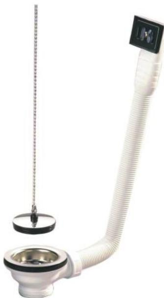
Bonde plastique avec trop plein et bouchon chaînette, pour évier grès de perçage Ø60mm. Epaisseur de serrage jusqu'à 35mm. Plateau inox et bouchon avec cache inox.
