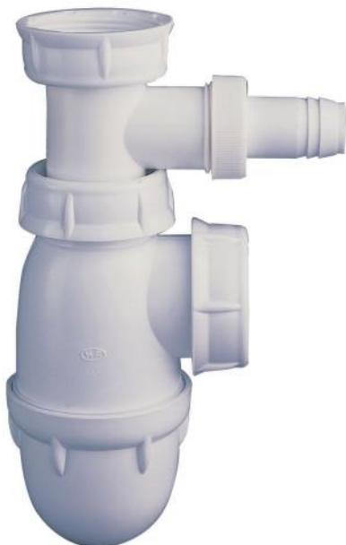
Prise machine à laver Ø22mm. Réglable en hauteur de 189mm à 244mm (encombrement de 94mm compris). Connection à la bonde en G 1 1/2".
