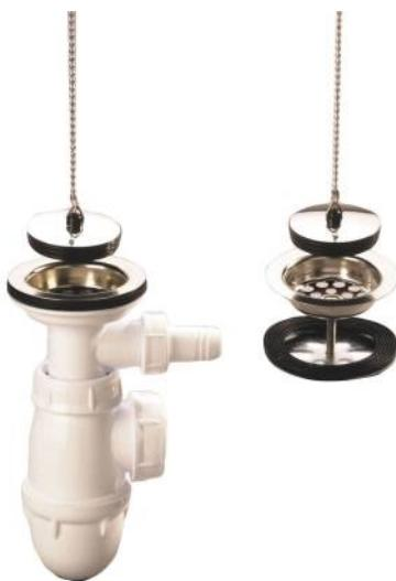
Vidage complet pour évier grès 2 bacs avec trop plein intégré incluant 2 bondes avec bouchon chaînette et 1 siphon réglable en hauteur avec prise machine à laver. Epaisseur de serrage des bondes jusqu'à 66mm. Siphon réglable en hauteur de 149mm à 189mm (encombrement de 92 mm inclu). Plateau inox et bouchon avec cache inox.
