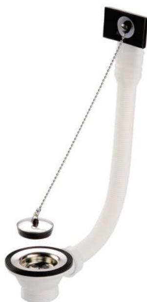
Bonde en plastique avec trop plein et bouchon chaînette, pour évier inox de perçage Ø50mm. Hauteur de serrage jusqu'à 12mm, encombrement sous évier 50mm. Plateau inox et bouchon avec cache inox.
