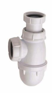
Siphon en polypropylène, tube réglable de 45 à 85mm, encombrement de 87mm. Culot démontable, écrous ergonomiques pour vissage manuel facile.
