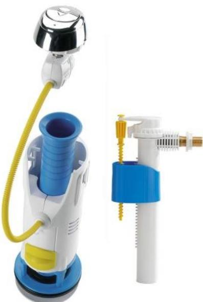
Mécanisme double vidage à câble. Perçage de couvercle de diamètre 16 à 50mm. Surverse réglable en hauteur. Robinet flotteur silencieux.
