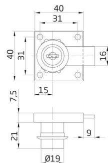
Serrure de meuble en acier au carbone nickelé de haute qualité avec languette droite en acier nickelé de 16 mm. Livré avec 2 clés.
