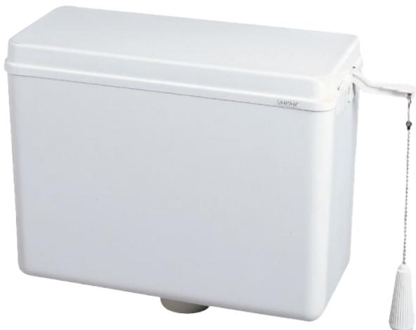
Réservoir plastique haut garni d'une isolation interne en polystyrène expansé, actionné par chaînette, équipé d'une soupape et d'un robinet flotteur à fermeture mécanique. Livré sans tube.
