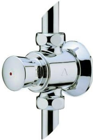
Robinet poussoir temporisé pour douche. Ce robinet résiste à une température de 75°C durant 30 minutes dans le cadre de chocs thermiques. Temporisation de 20 à 35 secondes.
