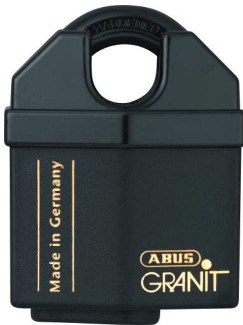
Boîtier et anse en acier spécial cémenté. La protection de l'anse rend l'accès pratiquement impossible aux outils d'attaque d'usage traditionnel, anti-perçage et anti-sciage. Double verrouillage à billes. Livré avec 2 clés lumineuses et une carte de reproduction.
