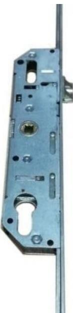
Crémone réversible à bariquet européen avec pêne 1/2 tour ajustable en partie haute par prolongateur pour porte-fenêtre 1 ou 2 vantaux en bois. Verrouillage haut et bas par relevage de bâquille (2 sorties de tringle). En acier traité FerGuardargent.
