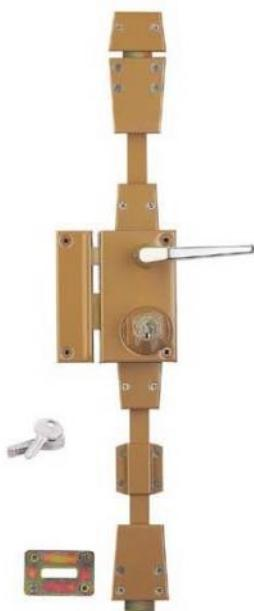
Mécanisme intérieur type équerre permettant la manoeuvre du 1/2 tour de l'intérieur comme de l'extérieur avec la clé. Manoeuvre de l'extérieur possible, même si une clé est restée dans la serrure à l'intérieur.
