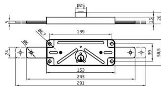
Serrure en métal pour la fermeture de l'obturateur. Actionnement extérieur et intérieur avec clé. Leviers latéraux en acier bichromaté (2 points de fermeture). Déplacement 24 mm avec un tour de clé. Coffre et couvercle en acier zingué. Cylindre rond avec 3 goupilles. Inclus 3 clés en laiton nickelé. Modèle 462/1 et 462/2 avec clés égales. Ébauche de clé modèle 4642.
