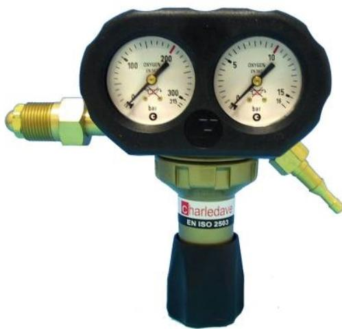
Détendeur blindé. Adapté aux travaux sur chantiers. Pression de 300 bar. Pression de sortie stabilisée. Résistance aux basses températures. Filtre dans la queue d'entrée retenant les impuretés. Grande souplesse de réglage, volant de réglage imperméable. Olive de sortie étagée : 6,3x12 et 10x17
