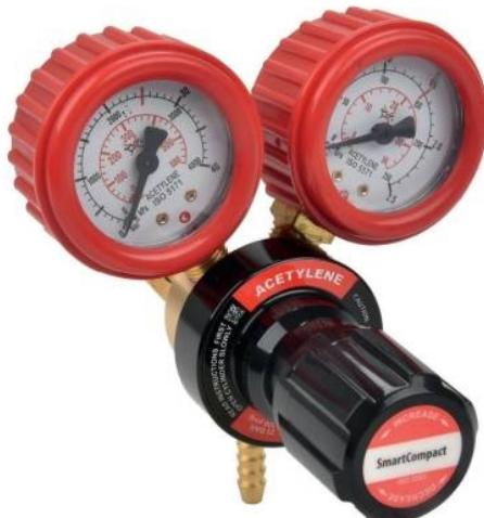
Détendeur type "Mickey". Le détendeur SmartCompact se distingue par sa conception, ses performances et finitions supérieures. Il est idéal avec son entrée arrière pour équiper les postes mobiles et petites bouteilles de gaz. Ses plages de réglage sont adaptées aux opération de brasage, soudage flamme et MIG et oxycoupage jusqu'à 50mm. Classe DFW.
