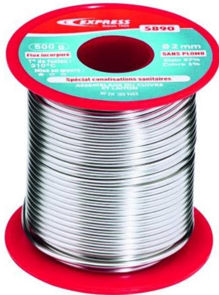
Soudure à l'étain pour assemblage de canalisations sanitaires (eau potable). Sans âme décapante. Qualité 1ère fusion. 97% étain / 3% cuivre. Flux incorporé CR 2,2%. Température de fusion : 310°C
