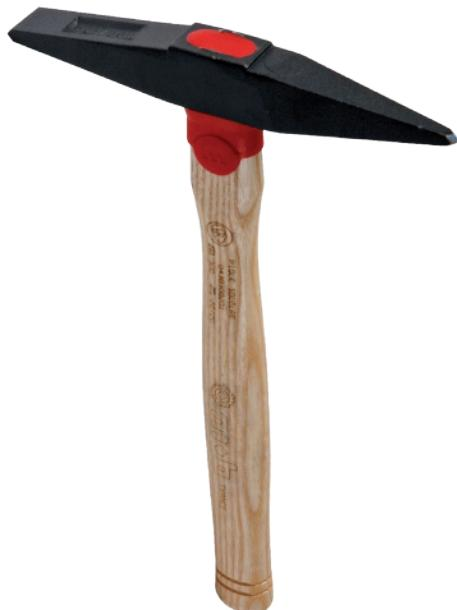
Tête forgée aux zones de dureté contrôlées. Traitement thermique par induction des surfaces travaillantes. Procédé d'emmanchement performant par coin de sécurité. Dureté de 52 à 58 HRC.
