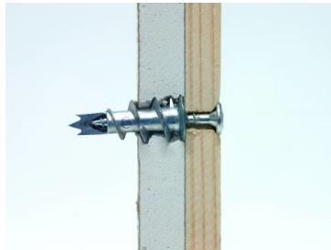
La fixation métallique auto-perceuse GKM usine son propre taraudage dans la plaque de carton-plâtre.
