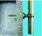
La cheville PC en polypropylène possède une collerette supportée par des stries de blocage s'opposant à toute rotation de la cheville lors du vissage. L'extrémité arrondie et pleine permet un enfoncement facile dans le forage et un effort d'expansion maximum.
