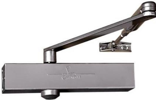
Ferme porte coupe-feu hydraulique à force variable 2 à 4, bras réglable, utilisable sans plaque de montage. Vitesse de fermeture et à-coup final réglables par vis pointeau. Clapet de surpression de série. Fixations invisibles dissimulées par capot clipé. Pose sur tout type de menuiserie (bois, alu, PVC, acier).
