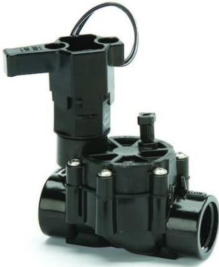
Vannes électriques plastique destinées aux installations d'arrosage résidentielles et publiques de petites dimensions. Configuration en ligne. Double filtration : au niveau de la membrane et du siège du solénoïde. Débit : 0,05 à 9 m<sup>3</sup>/h. Pression de fonctionnement : 1 à 10,4 bar à 23°C.
