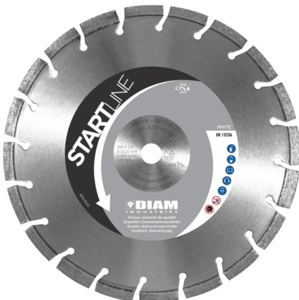
Disque mixte entrée de gamme de qualité. Haute concentration en diamant. Grande vitesse de coupe. Encoches inclinées. Segments droits de protection contre le laminage sous segment. Le disque mixte est conçu pour la découpe de divers matériaux. Pour éviter une usure prématuée, pensez à alterner les matériaux. Pour : acier creux ou de faible épaisseur, béton, asphalte.
