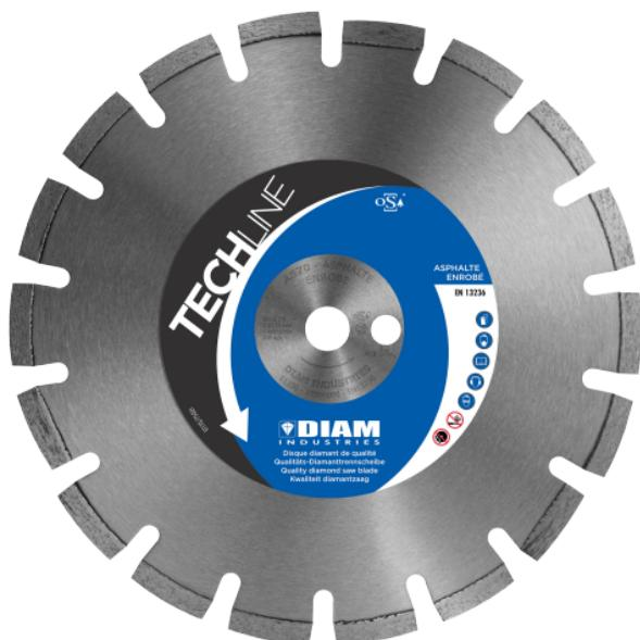
Disque performant pour les coupes de moyennes à longues distance. Segments inclinés de protection contre le laminage sous segment. Encoches "U" pour un meilleur dégagement des poussières. Tôle renforcée. Haut rendement. Très longue durée de vie. Haute concentration en diamant. Conçu pour les machines allant jusqu'à 9,5 kW. Pour : asphalte, enrobé, matériaux abrasifs.
