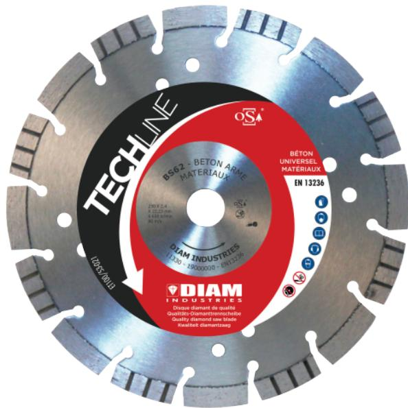
Disque bénéficiant d'un excellent rapport qualité/prix dans la gamme mixte. Tôle perforée, ventilée. Encoches courtes et inclinées pour une plus grande vitesse de coupe. Forte concentration diamantée pour une durée de vie rallongée. Pour : béton, acier, fonte, matériaux abrasifs.
