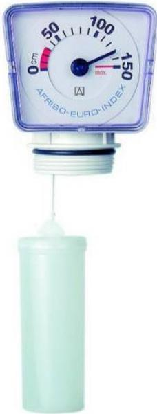
Jauge mécanique pour mesure de niveau à lecture directe. Indication permanente du contenu du réservoir en centimètres de hauteur de fioul. Cadran réversible avec 2 étendues de mesure (0 à 1500 mm et 0 à 2500 mm). Zone rouge. Joint d'étanchéité « anti odeur » sur la vitre et le raccordement au réservoir. Compatible bio-fioul.
