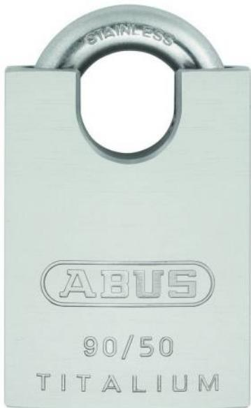
Boîtier massif en aluminium spécial Titalium™ et anse en inox 303 de qualité très élevée. Pièces intérieures en matériaux non-corrosifs. Cylindre de précision à 6 goupilles.
