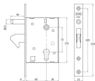
Serrure à encastrer pour menuiserie métallique avec guide et pêne dormant avec crochet de fermeture. Logement pour cylindre profil européen de came de 15 mm. Entreaxe: 72 mm. Carrée fouillot de 8 mm. Têteière et gâche en acier zingué.
