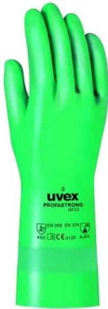
Gant de protection pour les risques chimiques. Gant supporté en coton floqué enduit d'un revêtement nitrile. Bonne préhension en milieu humide et pour les manipulations des acides, des graisses et des solvants. Exempt de silicones. Épaisseur 0,38 mm.
